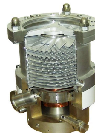
Turbo(molekular)pumpe Quelle: wikipedia.de; User:Liquidat
